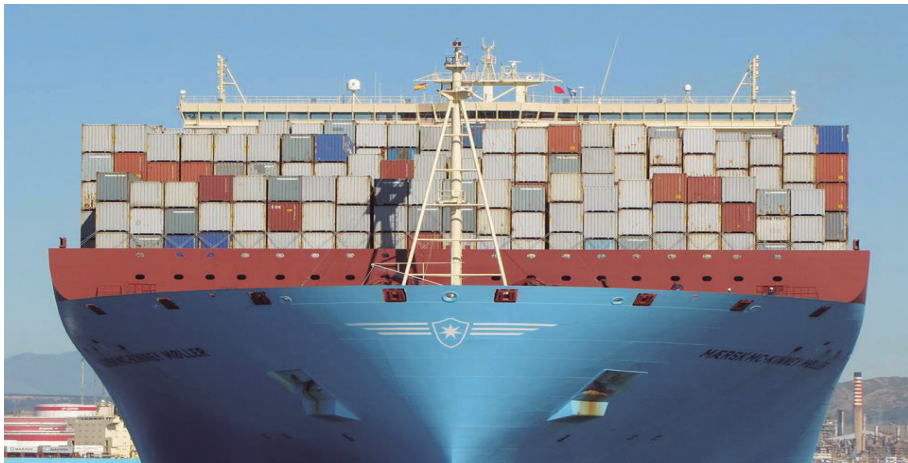
Tier: altura de ubicación del contenedor, plano vertical.
